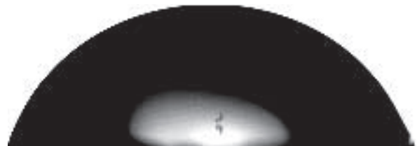
Bild 3: Wassertropfen auf dem unbehandelten Substrat. Kontaktwinkel: 76°.
