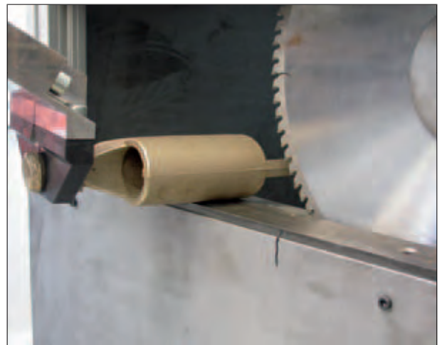
Bild 5: Roboter führt Teil zum Abtrennen des Steigers
