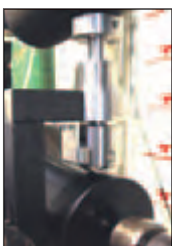
Bild 5: Walkvorrichtung auf eine Drehmaschine montiert. Simulation der Kräfte von Führungsbändern und Dichtungen auf die Beschichtung.
