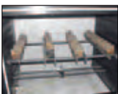
Bild 4: Proben in der Kammer für Salzsprüh- und Kondenswassertest nach fünf Zyklen.
