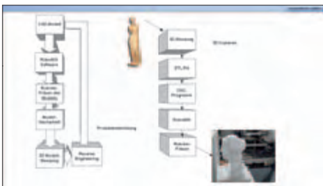
Bild 2: Einsatzfälle für das Roboterfräsen von Styropormodellen können im Modellbau gefunden werden. Aber auch bei der Produktentwicklung werden Anschauungsmodelle benötigt, die mit dem Roboter schnell und preiswert gefertigt werden. Weitere Anwendungen sind in der Baudenkmalpflege die Erstellung von Replikaten.
