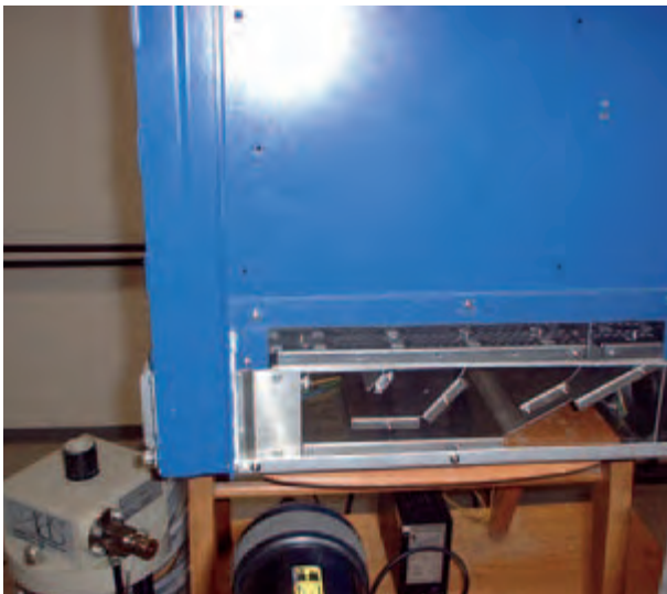
Bild 1: EDV-Baugruppenträger mit Lüftereinschub
