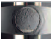
Bild 3: Beschichtungstemperatur 180 °C. Adhäsionsbruch Beschichtungs-Substrat. Die hellgrauen Stellen ist Metall der Kolbenstange.
