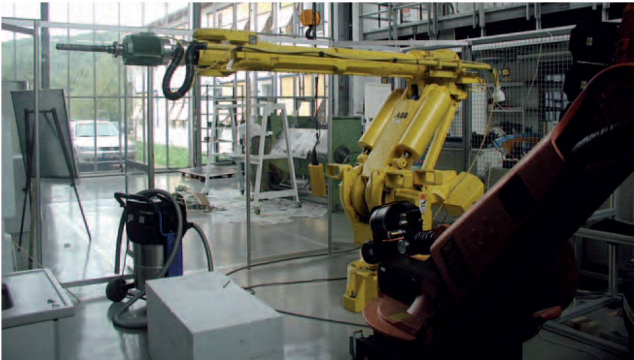
Bild 5: Im Labor des Instituts für Betriebs- und Technologiemanagement in Birkenfeld/Nahe wurde ein ABB 8600 Roboter mit Zusatzachse eines großen Automobilherstellers zur Entwicklung und Erprobung des Exportfräsens aufgebaut. Zum Fräsen wurde ein Raspelfräser mit Löchern eingesetzt, bei dem die Späne durch die Hohlwelle des Antriebsmotors abgesaugt werden. Der Roboter befindet sich mittlerweile wieder im Automobilwerk, in dem der industrielle Einsatz realisiert wird.
