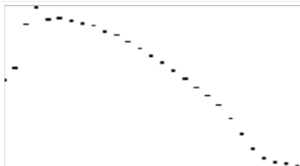
Abb.1 Gemessenes Brechzahlprofil n(r) einer Multimode-Faser
