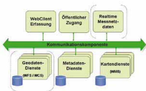
Abb.2: Generische Architektur des Forschungsservers. Die geklammerten Komponenten werden erst in der zweiten Phase des Systemaufbaus realisiert
