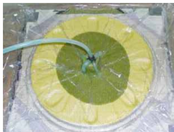
Abbildung 4: Vakuuminfusion der Felgen aus Kohlefaser
