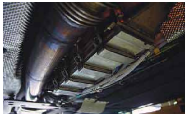
Blick auf thermoelektrische Generatoren, die an den Auspuff eines PKW angebaut sind; Quelle: BMW
