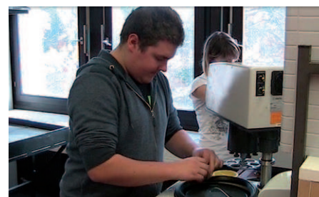
Auch das Polieren der metallografischen Schlitte will gelernt sein
