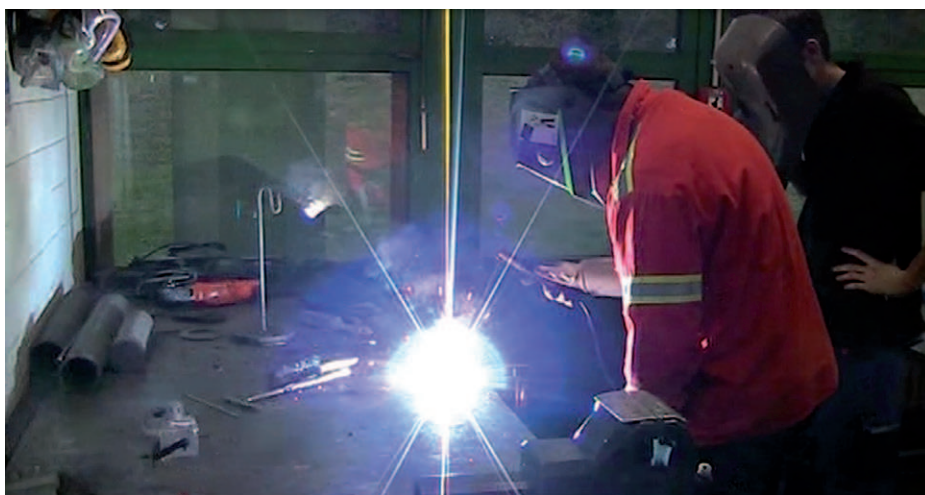
Schweißen mit dem MAG-Verfahren – nicht immer ganz einfach
