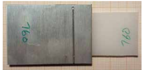
Bild 5 • Draufsicht auf eine laserstrahlgeführte Probe aus Aluminium und Polyamid 6.6 im Überlappstoß.
