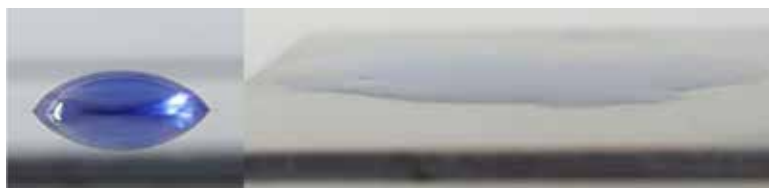
Bild 7 • Tropftest der Oberflächenenergie; links: unbehandelte Aluminiumoberfläche, rechts: speziell behandelte Aluminiumoberfläche.
