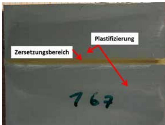
Bild 10 • PVC-Rückstände auf der Aluminiumoberfläche nach Trennung der gefügten Proben.
