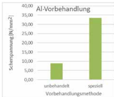
Bild 9 • Steigerung der errechneten Scherspannungen der laserstrahlgefügten Aluminium/PA-6.6-Proben durch spezielle Vorbehandlungsmethoden der Aluminiumoberflächen.
