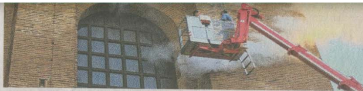
Trierer Meteorologen zeigen mit Nebelschwaden, wie die Luft an der Basilika-Fassade entlangströmt.
