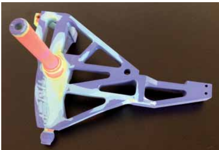
Abb. 2: Prototyp eines Radträgers als Anschauungsmodell mit aufgedruckter Spannungsverteilung eines Lastfalls aus einer FEM-Berechnung (Projekt proTRon)
