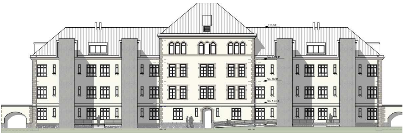
Abb. 23: Geplante Treppenhäuser an der Nordseite des Gebäudes 2
