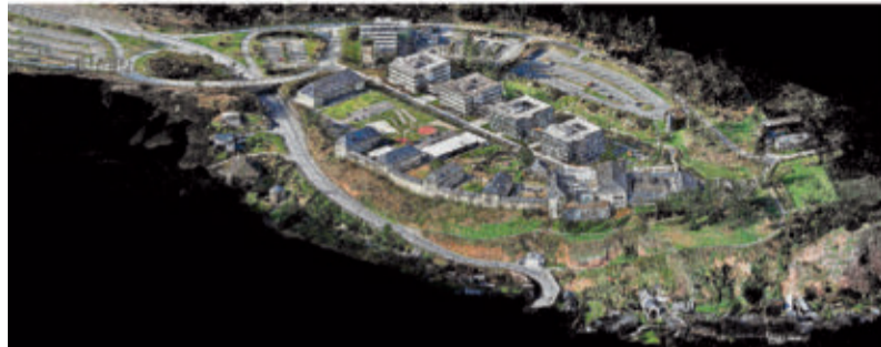
Sieht fast aus wie ein Foto: Diese Punktwolke ist eine der Grundlagen für das spätere mehrdimensionale digitale Modell vom Campus.
