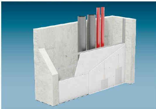
Abbildung 5: Konstruktionsbeispiele für Schachtwände der Firma Knauf
